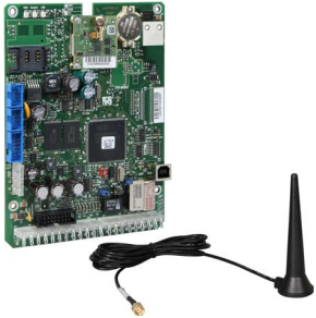
Beispiel: comXline 1104 (LTE) als Einbausatz
